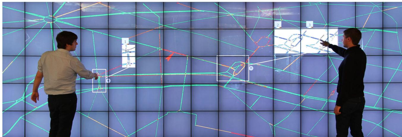
Mur d'écrans interactif de 5,9m × 1,96m (14 400 × 4 800 pixels). Ce mur est tactile grâce à un cadre PQ labs.
