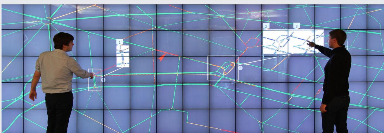
Prototype collaboratif d'un système de contrôle de trafic routier fonctionnant sur un mur d'écran haute résolution. En plus des interventions classiques, il permet aux opérateurs de simuler l'impact de leurs actions sur le réseau avec des techniques de visualisation locales et globales.
